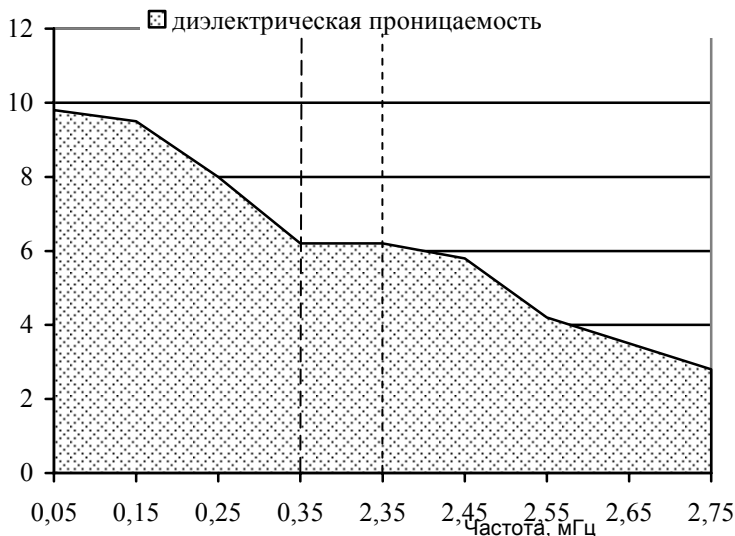
Рис. 6. Зависимость диэлектрической проницаемости карбонатапатита от частоты электромагнитного поля
