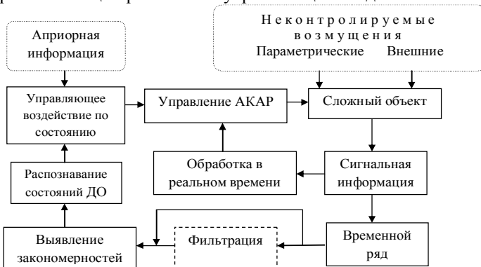
Рис. 11. Схема совмещения управления по АКАР с коррекцией по апостериорной информации о классе состояния сложного объекта
