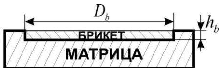
Рисунок 14 – Схематичное изображение матрицы для прессования частиц порошка
