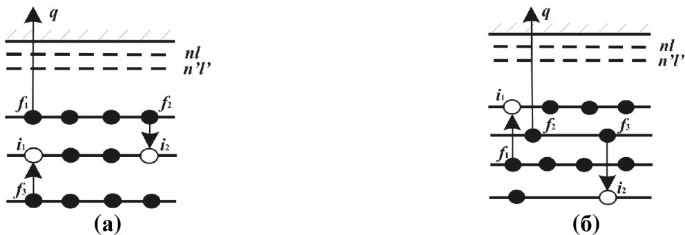
Рис. 4. ТЭО-переходы с “углублением” (а) и “встречным движением” (б) вакансий.
