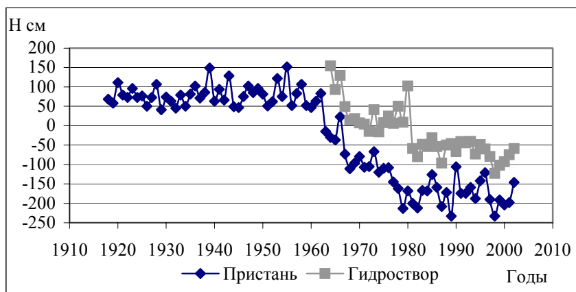
Рис. 2. Изменения минимальных уровней воды на водомерных постах у г.Томска (над «0» соответствующего поста)
